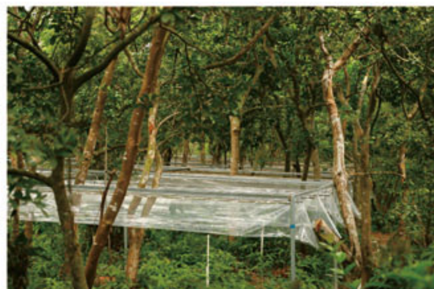
正在运行的小良站降雨控制试验平台
